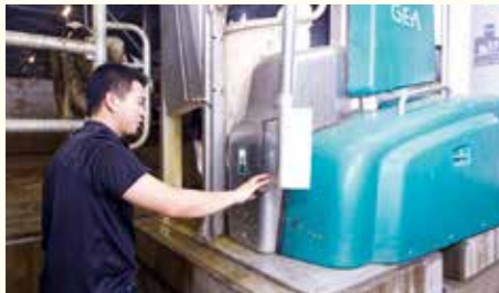
ロボット搾乳機を備えたフリーストール牛舎。各所に監視カメラを設置し、モニターでチェックする
