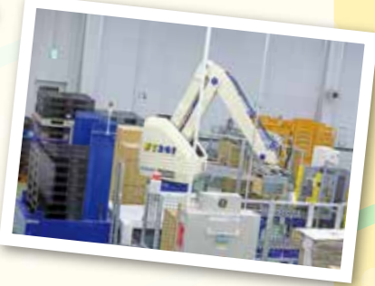
業界初の段ボールを積み上げる 作業専用の機械を開発した
