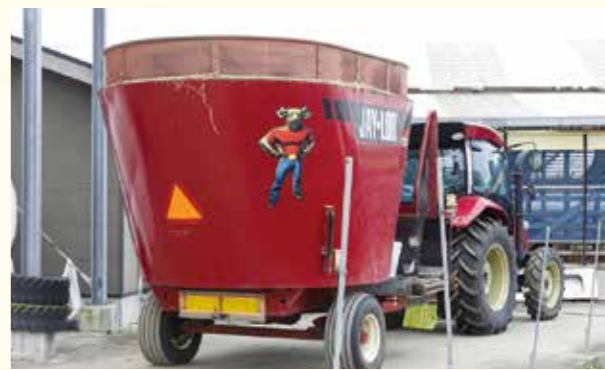
TMRのミキサーを装着したトラクター
